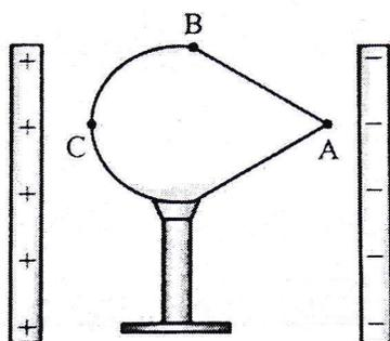
در شکل روبه‌رو، جسم رسانای منزوی و خنثی که روی پایه عایقی قرار دارد، بین دو صفحه رسانای باردار موازی، در تعادل الکترواستاتیکی قرار دارد.
