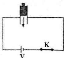
مطابق شکل خازنی که بین صفحه‌های آن هوا است. در مدار قرار دارد، ابتدا کلید را باز کرده و سپس یک دی‌الکتریک بین صفحه‌های خازن وارد می‌کنیم، جدول زیر را در مورد این خازن با کلمه‌های (کاهش - افزایش - ثابت) پُر کنید.
